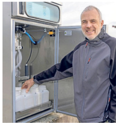
Der für Abwasserüberwachung zuständige Abteilungsleiter Jürgen Feuerer zeigt, wo auf der Kläranlage die Proben abgezapft werden, die später ans Labor geschickt werden. Fotos: Alex
